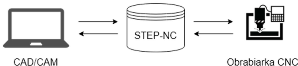
rys. 3-5 Sposób programowania obrabiarek CNC z wykorzystaniem STEP-NC [źródło własne]
